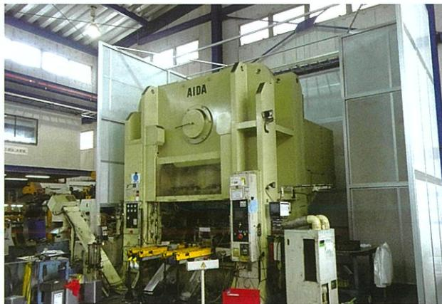
大きな設備の側面に防音パネルを置くだけで、防音効果が期待できる。
